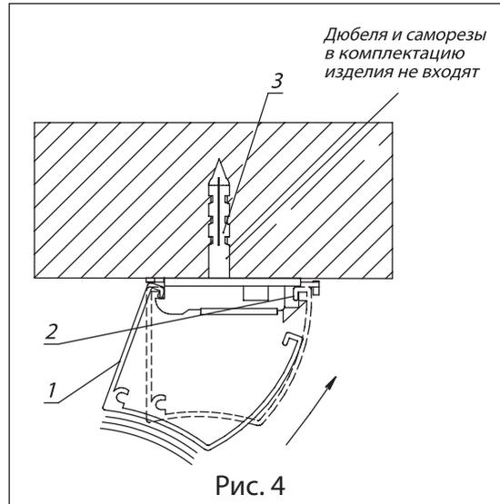
1. Отсоедините Г-образный уголок (1) от кронштейна (2), открутив болт (3) соединяющий эти детали (см. Рис. 3).
