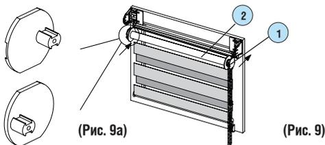
8. Вставьте C-образный профиль с тканью (1) в паз фиксатора кронштейна (2) как показано на рис. 10. В образовавшуюся петлю из ткани аккуратно вложите круглый утяжелитель.
