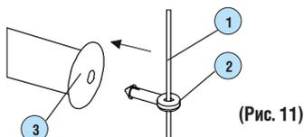
10. Проденьте леску (1) через фиксатор лески в нижних кронштейнах (2). Определите местоположение нижних кронштейнов (2) таким образом, чтобы сохранялась параллельность лески (1). Прикрутите кронштейны (2). Натяните леску (1) и зафиксируйте ее с помощью стопорного винта (См. рис. 12).
